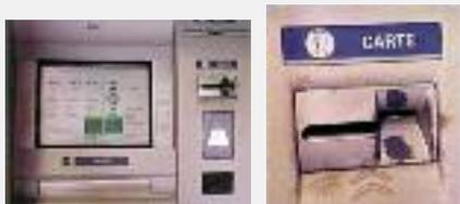
Le dispositif de skimming se caractérise par un aspect usé qui contraste avec l'apparence high-tech et récent des GAB. Parmi les dispositifs de skimming, nous pouvons distinguer: les skimmers des pistes magnétiques, les skimmers des cartes à
